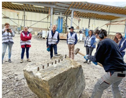
Nicht alles geht maschinell: «mundgerecht» spalten für die weitere Verarbeitung durch die grosse Spaltmaschine.
